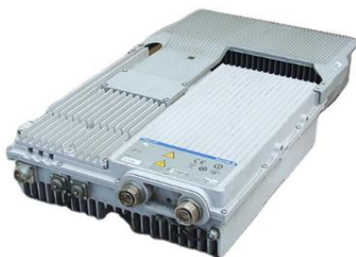
Slika 10.15 Izgled modula i panela RRU5509t
