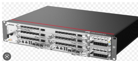
Slika 10.1 Izgled modula BBU5900
